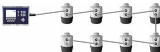
Сеть новых датчиков веса POWERCELL PDX (без соединительного короба)
