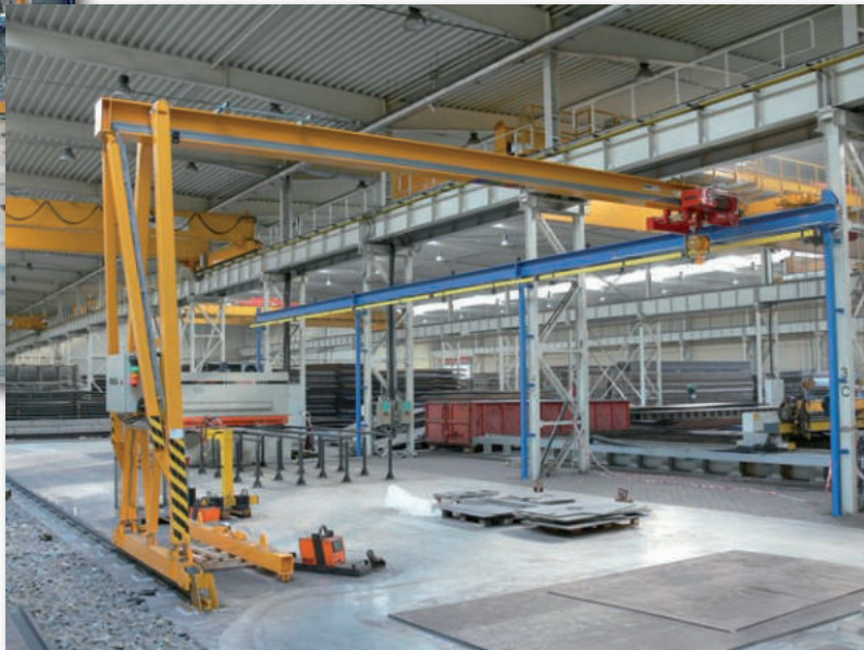
Полукозловой кран GIGA mun GPMJ 5t/9,5m Заказчик - UnionOcel, s.r.o, Прага, Место установки - производственный завод Копршивнице
