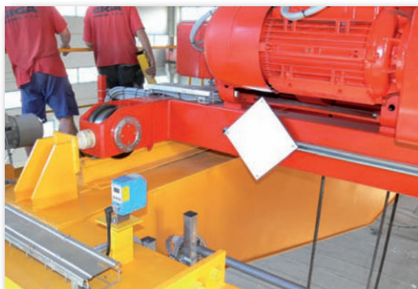
Мостový jeřáb GDMJ 12,5t/27,9m, vybavený pozicováním kladkostroje Místo instalace: Presbeton, s.r.o., Olomouc
