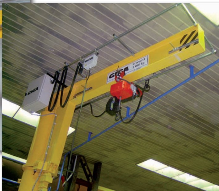
Электрический цепной тельфер CH3 1000.5-JE, установленный на колонном консольном кране GIGA mun GSOJ 1t/3,25m
