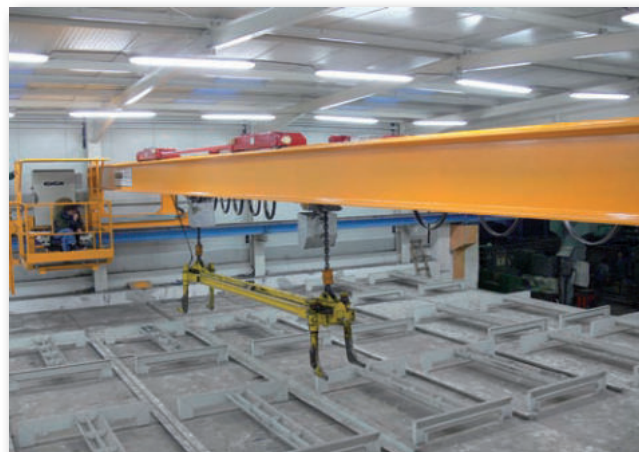
Двухбалочный мостовой кран GIGA mun GDMJ 3,2t+3,2t/14m
