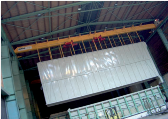
Однобалочный мостовой кран GJMJ 2,5t+2,5t/23,8m для цеха оцинковки с вытяжной установкой
