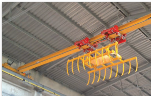
Мостовой кран GJMJ 2x0,8t/16m с грейфером для поднимания сена. Кран оснащён системой, предотвращающей раскачивание.
