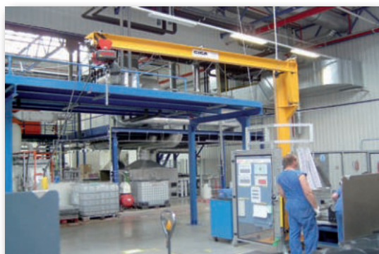
Колонный поворотный кран GSOJ 0,125t/4m
