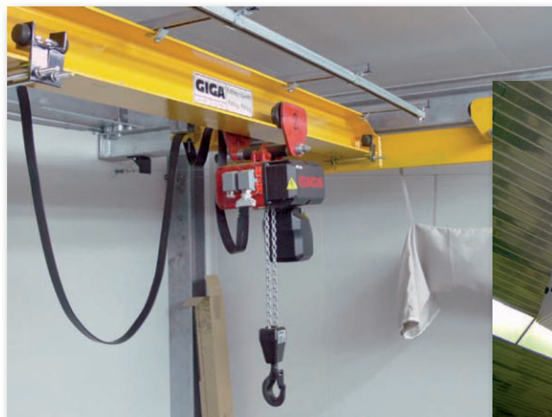
Электрический цепной тельфер CH1 500.4-J, установленный на подвесном мостовом кране GIGA mun GPMJ 2x 0,5t-4,2m. Заказчик - Benteler, s.r.o., Либерец, место установки - Австрия
