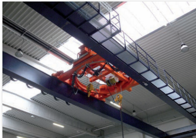
Мостовой кран GIGA mun GDMJ 20t/24,8m с поворотной тележкой
